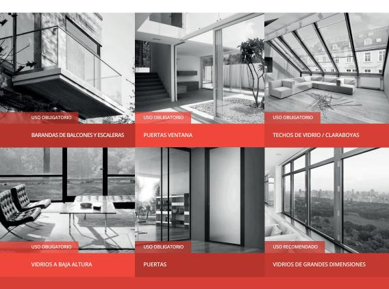
En barandas de balcones y escaleras, el vidrio debe brindar un grado mayor de seguridad ya que además de no lastimarnos, debe contenernos. En techos, debido a las consecuencias que pueden derivar de su rotura, deben ser siempre laminados.
